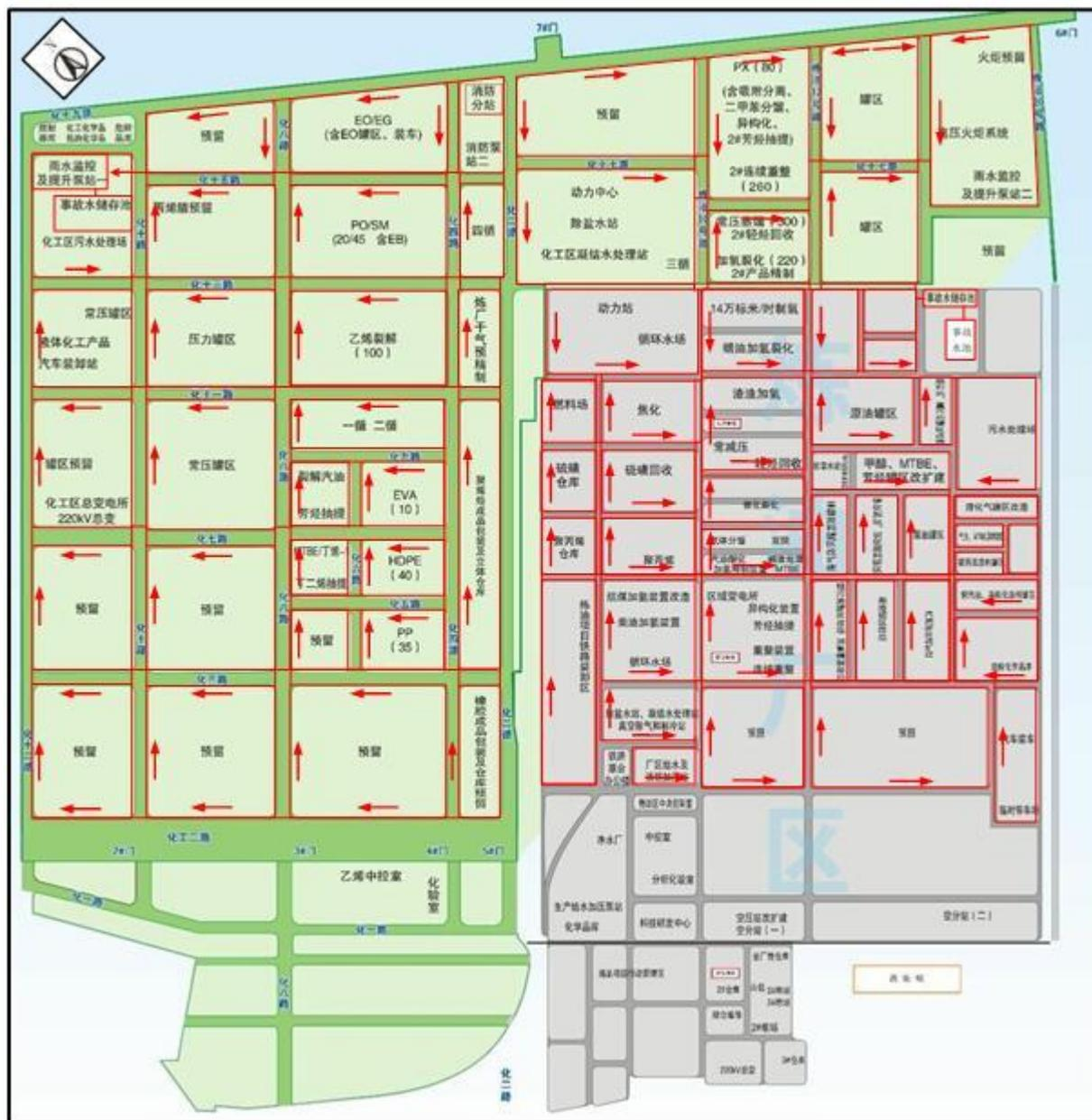
图 7.1-5 厂区事故废水流向控制图
